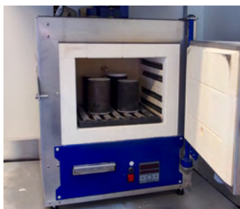
Platzieren Sie die Muffeln in einem gut belüfteten Ausbrennofen.
