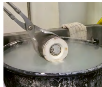
Schrecken Sie die Muffel ab und entfernen Sie sie, indem Sie sie in Wasser untertauchen.
