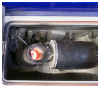
Durch Schleuder- oder Vakuumgussverfahren werden dünne Details besser gefüllt.
