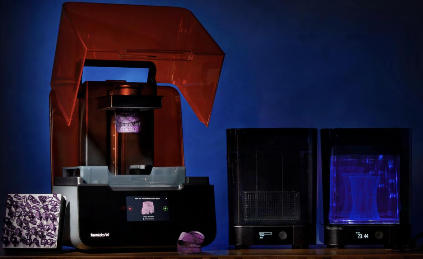
Hochauflösende Desktop-3D-Drucker wie der Form 3 von Formlabs haben den 3D-Druck von Schmuck für unabhängige Designer und Großgießereien gleichermaßen erschlossen.
