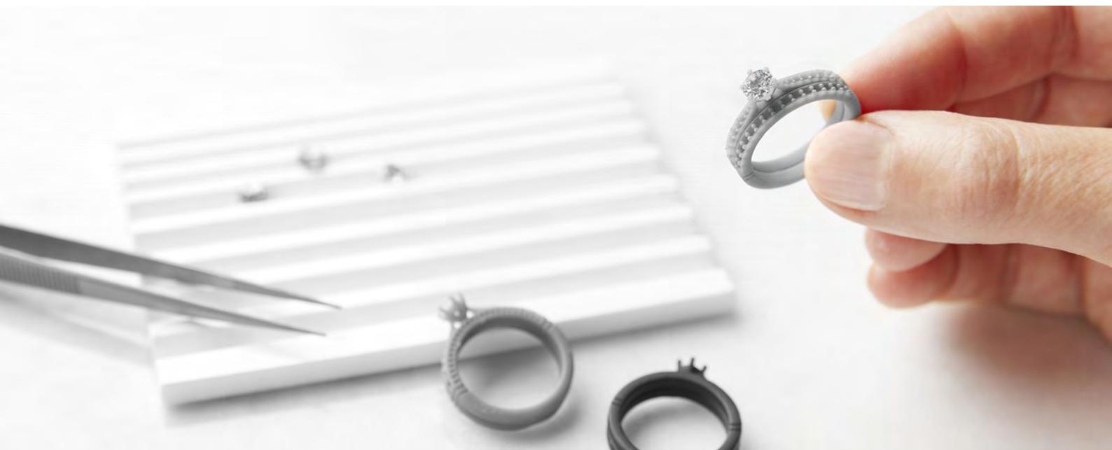
Der Juwelier kann das Design mit dem Kunden besprechen und ihm schon eine Stunde später ein echtes, physisches Modell des Rings zum Anprobieren anbieten. Im Schmuckeinzelhandel verkürzt das digitale Design direkt vor Ort gepaart mit der Geschwindigkeit des 3D-Drucks die Feedbackschleife zwischen Designer und Kunde drastisch.
